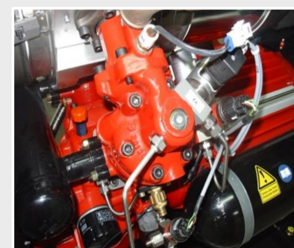
Θερμοκινητήρας συμπαραγωγής STIRLING
